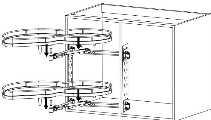
вытяните направляющие и установите полку, затем легко надавите на нее для равномерного расположения
