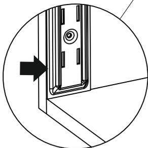
поставить вторую рейку на дно и закрепить ее на уровне с задней частью центральной перегородки
