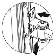
установите направляющие на нужную высоту и вставьте крепление в рейку, затем зажмите и затяните стопорный винт.
